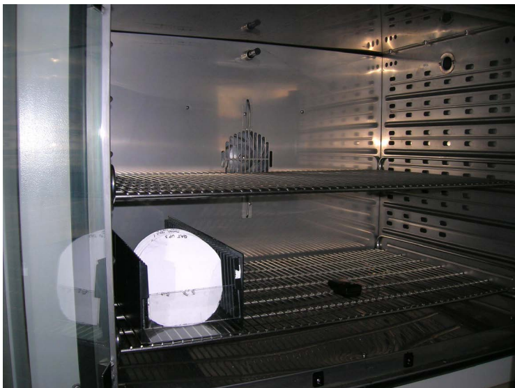
Klimabox mit Rack und Logger
