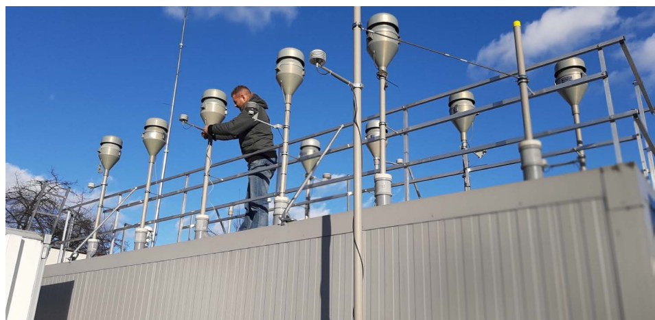
Abbildung 3: Aufbau aller Probenehmer im Mess- container. (© Umweltbundesamt)
