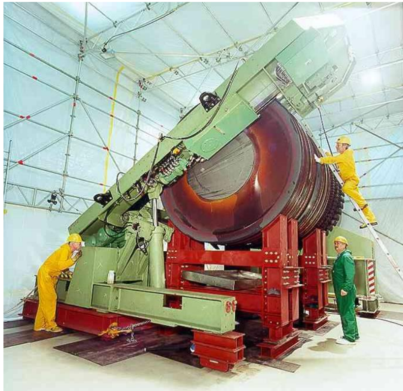
Abbildung 19: Zerlegen eines Turbinenläufers mit einer Bandsäge
