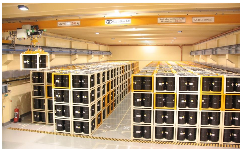
14. ábra: Radioaktív hulladékok technológiai tárolása az NRHT felszíni létesítményében
