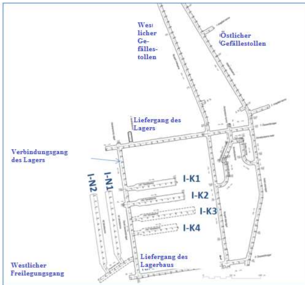
2-5. Abbildung Stollensystem des I. Kammerfeldes der NRHT
