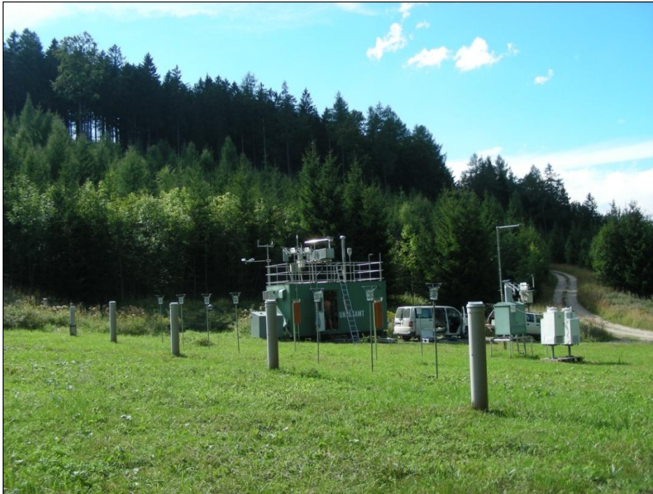
Abbildung 8: Messstelle Zöbelboden (Wildwiese) von Osten. Im Vordergrund stehen Niederschlags- und Staubniederschlags- sammler, rechts WADOS für die nasse Deposition. (© Umweltbundesamt/ Rokop)
