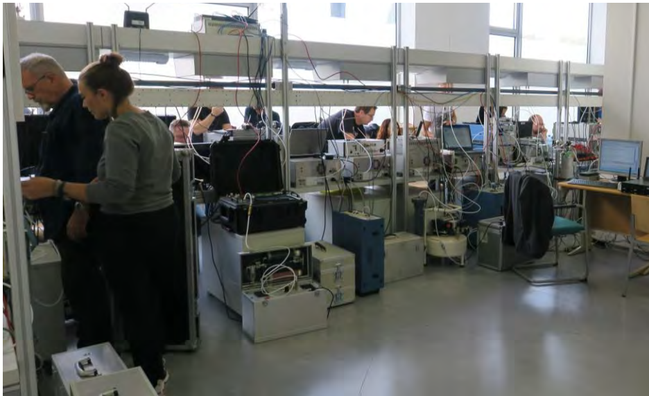
Abbildung 6: Anordnung der Arbeitsplätze gewährleisten eine freie Zugangsmöglichkeit zu allen Anschlüssen an der Geräterückseiten (© Umweltbundesamt)
