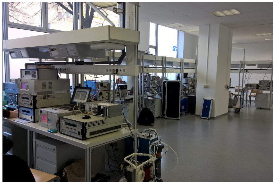
Abbildung 4: Die Anordnung der Arbeitsplätze gewährleistet eine freie Zugangsmöglichkeit zu allen Anschlüssen an den Geräterückseiten. (© Umweltbundesamt)
