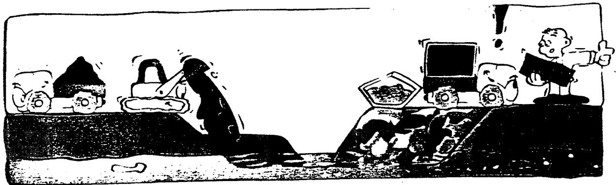
WIEDERAUFFÜLLUNG BIS ÜBER GRUNDWASSER, KONTROLLE UND ENTSORGUNG
